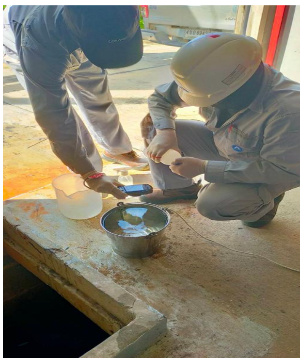
รูปที่ 2 การเก็บตัวอย่างน้ำบาดาลที่ บ่อเก็บน้ำใต้ดินตึก B
