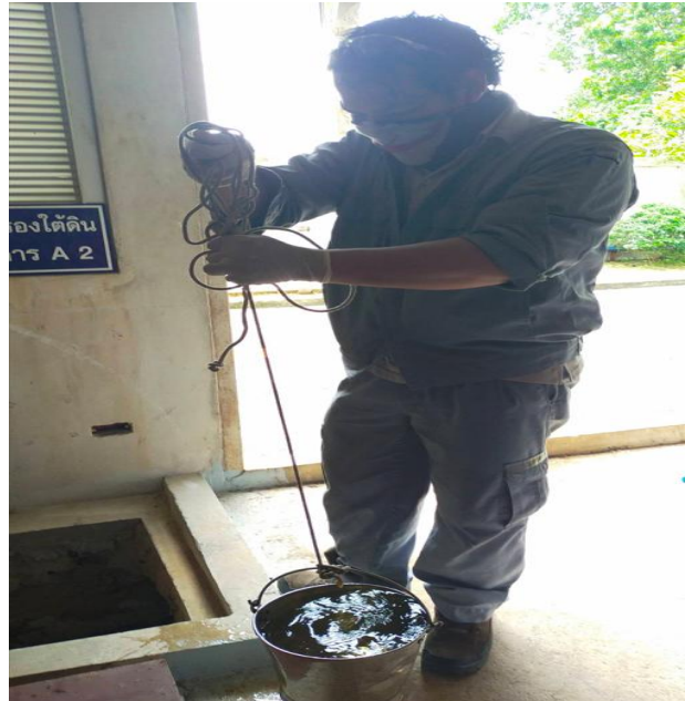
รูปที่ 1 การเก็บตัวอย่างน้ำบาดาลที่ บ่อเก็บน้ำใต้ดินตึก A
